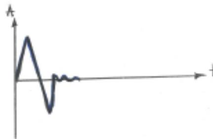
Пружинный изолятор с металлической подушкой имеет несколько меньшие изоляционные свойства, но очень хорошее демпфирование. После окончания действия возмущающего фактора, система быстро приходит в исходное положение.
