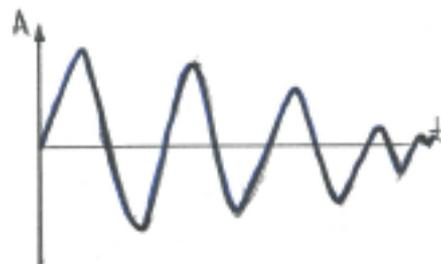
Пружинный изолятор имеет хорошие изоляционные свойства, но очень плохое демпфирование. После окончания действия возмущающего фактора, система продолжительное время приходит в исходное положение.
